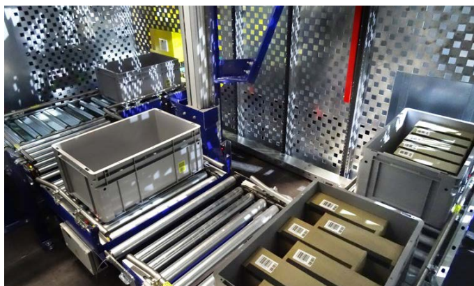
Behälter mit Akten auf dem Förderband auf dem Weg in den sauerstoffreduzierten Speicher. Foto zVg
